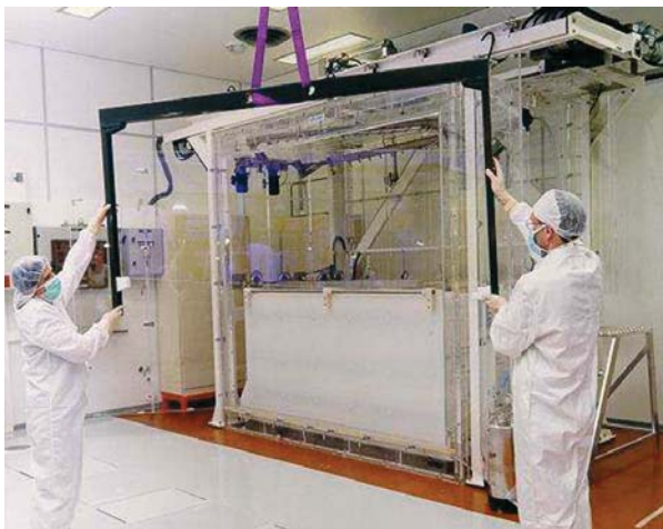
FIGURE 11 Lame pare-éclats de la LIL traitée antireflet large bande par trempage.
